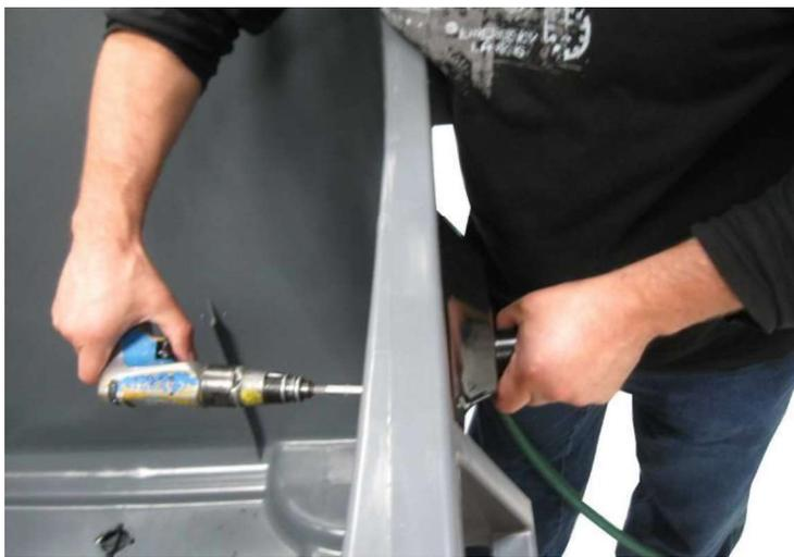
**3** Placer, sur un des côtés latéraux de la cuve, la préhension en vous aidant des détrompeurs.
