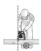
Utiliser un étau ou un serre joint si nécessaire, et caler/soutenir les chutes longues
