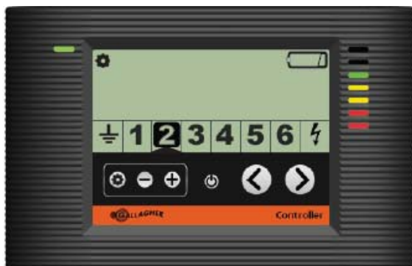
Der Display Controller zeigt, dass in Sektion 2 eine schwache Batterie vorhanden ist
