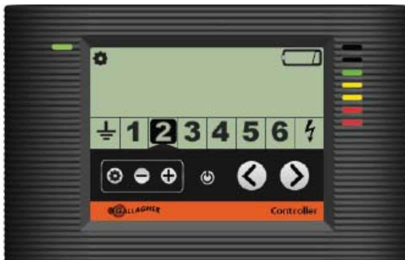
Styreenheden viser zone 2 med et lavt batteri
