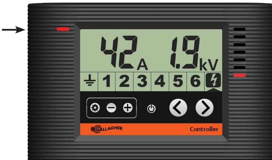
Kontrollenheten visar aggregatet i utgångslarm
