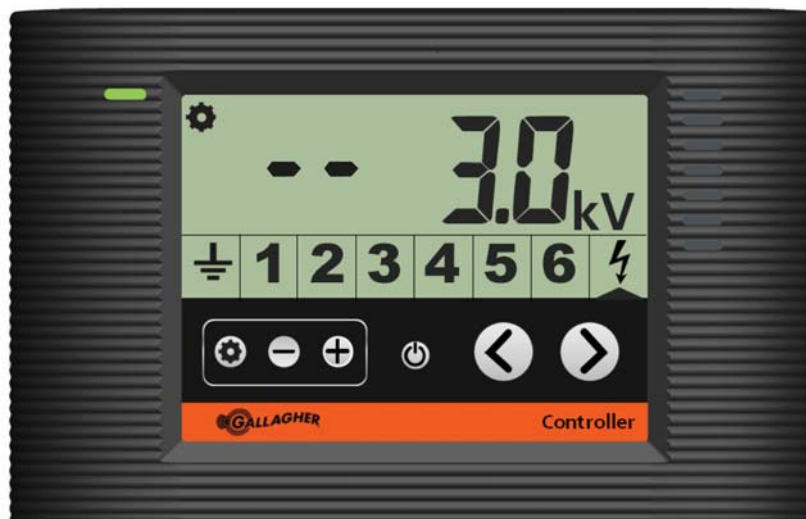
Bedieningspaneel toont de standaard schrikdraadapparaatalarminstellingen met stroomsterkte uitgeschakeld en spanning op 3.0KV
