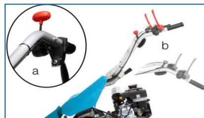
**Guidon réglable en hauteur, poignées ergonomiques** garantissant un meilleur confort pour l'opérateur pendant l'utilisation (Fig. b).
