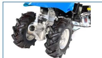
**Roues à profil agraire de 3,5 x 6"** garantissant une excellente traction sur n'importe quel type de terrain.
