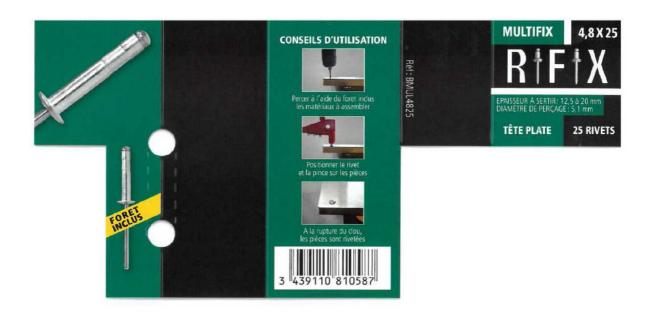
Ce rivet permet de serrer plusieurs épaisseurs avec une seule longueur, ce qui permet de réduire le stockage et il est spécialement utilisé pour l'assemblage dans les cas où il n'est pas possible de faire un trou avec un diamètre précis (ovalisation). Après rivetage, le Multifix conserve la tête du clou, ce qui évite les infiltrations d'eau.
