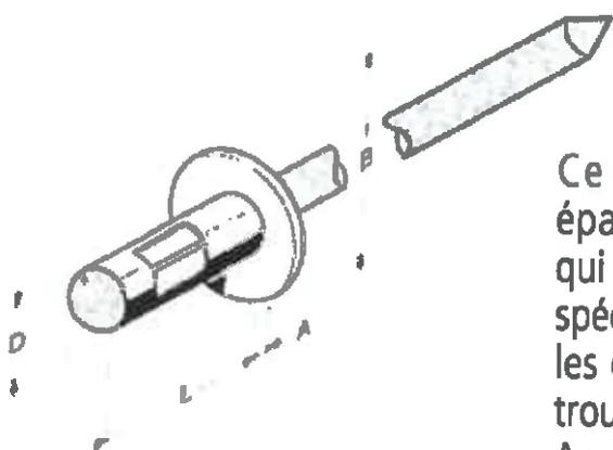
Ce rivet permet de serrer plusieurs épaisseurs avec une seule longueur, ce qui permet de réduire le stockage et il est spécialement utilisé pour l'assemblage dans les cas où il n'est pas possible de faire un trou avec un diamètre précis (ovalisation). Après rivetage, le Multifix conserve la tête du clou, ce qui évite les infiltrations d'eau.
