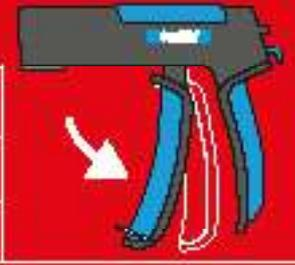
Nous garantissons la pose des chevilles M8 Scell-it avec cette pince à expansion Smartes. Pour la pose de chevilles à expansion d'autres marques et d'autres dimensions, il est conseillé de réaliser des tests au préalable.
