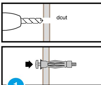
1 Percer le support au diamètre «dout» indiqué. Introduire la cheville à fleur du trou. Dévisser la vis de +/- 6 mm.
