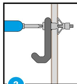
3 Retirer la vis pour positionner l'objet à fixer. Visser l'ensemble à l'aide d'un tournevis.
