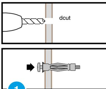
1 Wywierć otwór w podłożu o wskazanej średnicy „dcut”. Włóż kotwę równo z otworem. Odkręć śrubę o +/- 6 mm.
