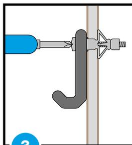
3 Odkręć śrubę, aby wstawić przedmiot do zamocowania. Przykręć całość za pomocą śrubokręta.
