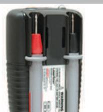
Fixation des pointes de mesure
