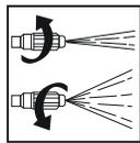
Buse à turbulence robuste et maniable pour régler précisément la qualité du jet : du jet droit pour une application localisée au jet brouillard pour une application d'ensemble.
