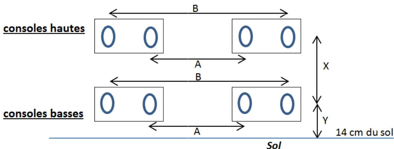
Vue de dos du radiateur avec positionnement des consoles
